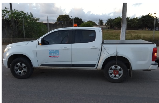
Ensaio de IRI em rodovia
